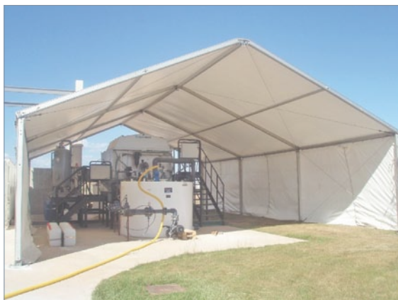
Filtración del efluente de un proceso Actiflo® mediante un Hydrotech Discfilter, en la planta de regeneración de agua de El Baix Llobregat, Barcelona, España.
