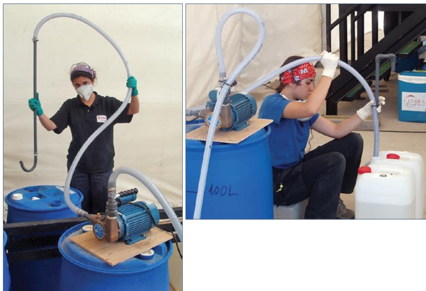
Figura 6: Bomba de aspiración y tubo con terminación curvada empleados para la extracción del sobrenadante de las muestras de agua efluente (izquierda) y de las muestras de agua afluente (derecha).
