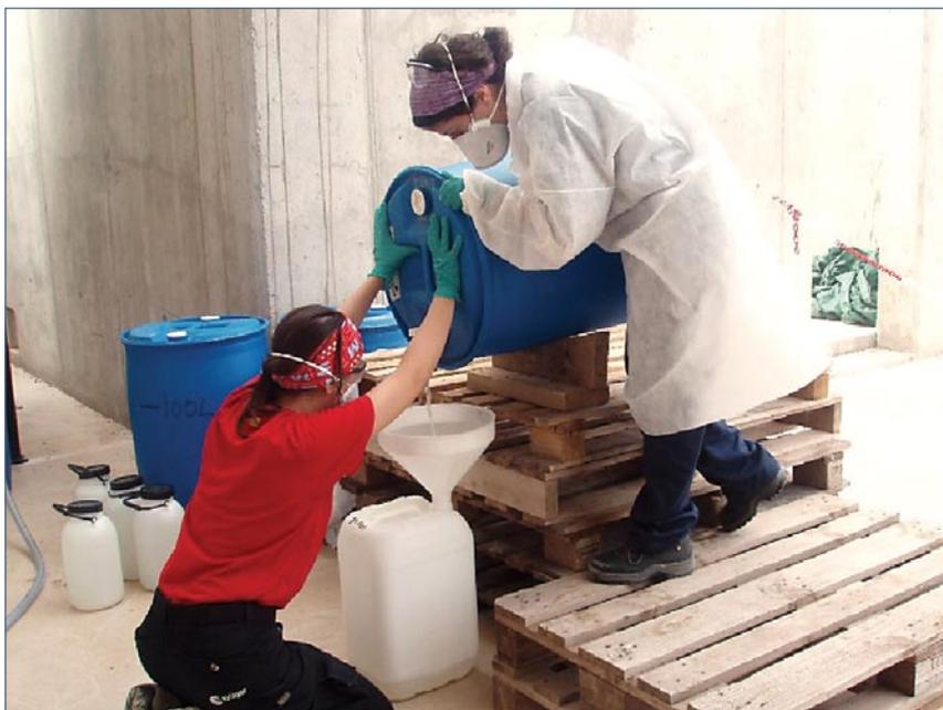
*Figura 7: Transferencia de los 20 litros restantes en un bidón de agua efluente a un bidón de 25 litros.*
