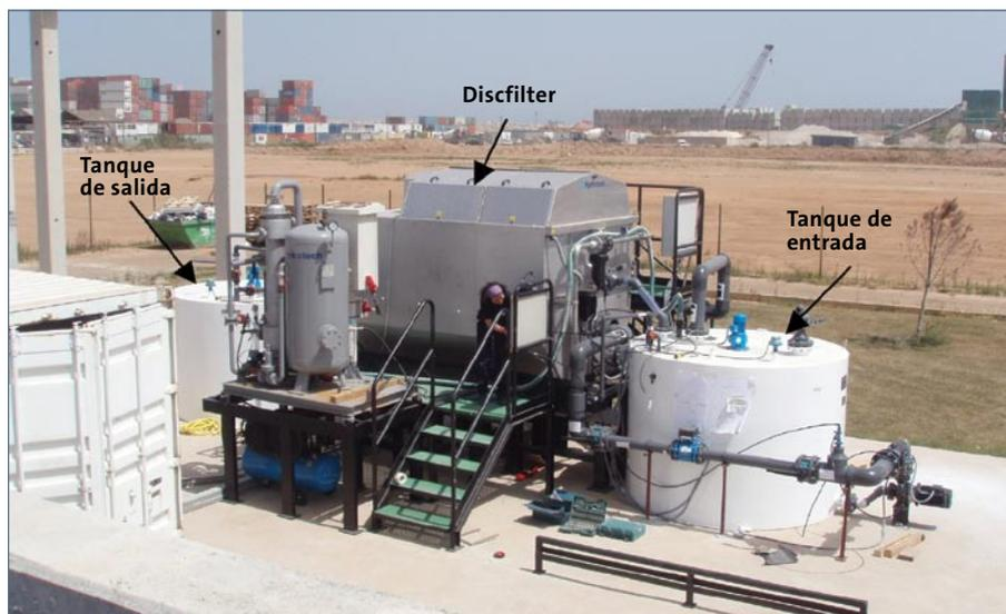
**Figura 3:** Vista inicial de la planta de demostración, desde la planta de regeneración de agua de El Baix Llobregat, antes de instalar la carpa. El depósito de agua afluente aparece en la parte derecha y el de agua efluente a la izquierda.
